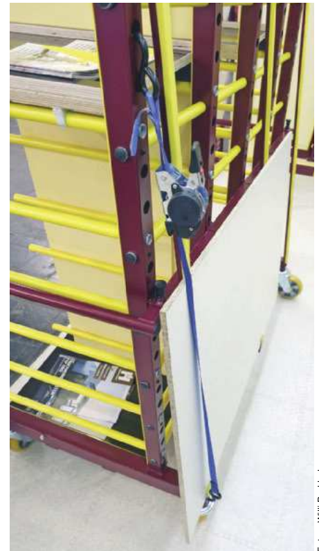
... und mit Gurtsicherung gegen ungewolltes Umkippen großer Platten
